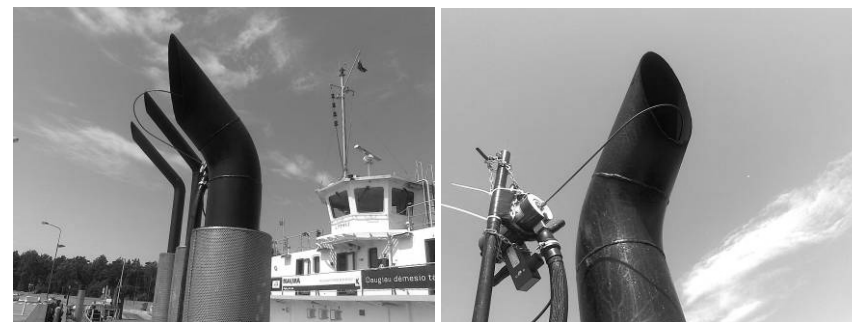
1 pav. Išmetamųjų dujų koncentracijų matavimas kelte.
